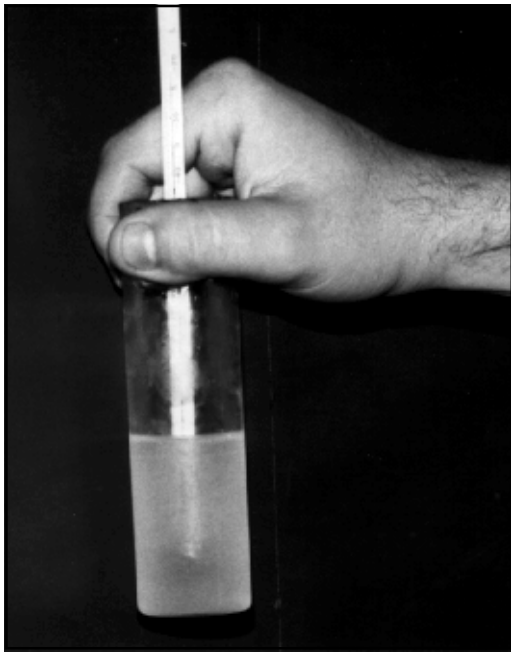
Figura 10.5 - Procedimiento para determinar el punto de floculación.
