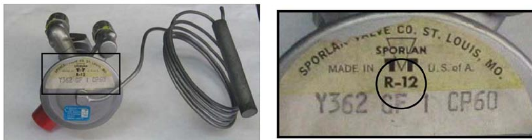
Figura 14. Una etiqueta en una válvula de expansión
