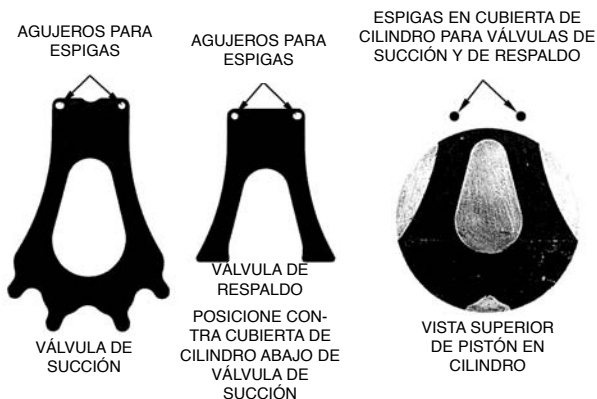
Fig. 5 – Posiciones de Pistón, Válvula de Succión y Válvula de Respaldo (06E)
